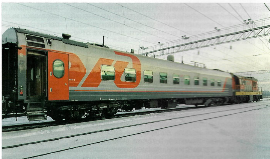
Сетевой вагон-лаборатория Центральной станции связи
