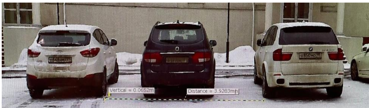
Рис. 3. Иллюстрация замеров боковых интервалов между автомобилями марки HYUNDAI Elantra (B648HM777) и BMW X5 (A850MO90)
