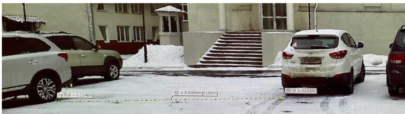
Рис. 4. Иллюстрация замеров расстояния между автомобилями HYUNDAI Elantra (B648NM777) и MITSUBISHI ASX (A735YU777)
