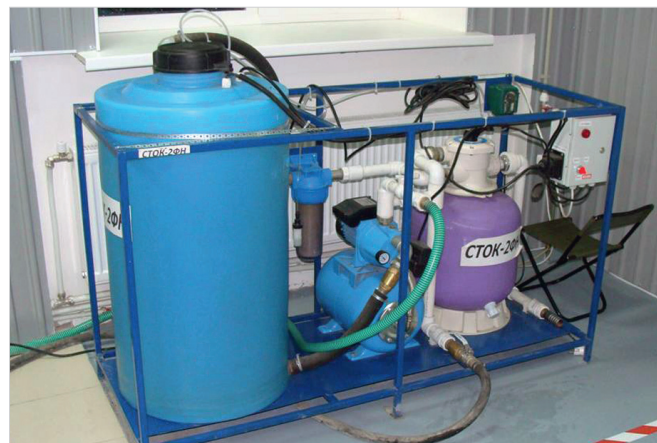
Очистное устройство автоматической моющей машины X53
