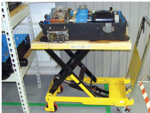
Транспортная тележка с регулируемой высотой грузовой платформы
