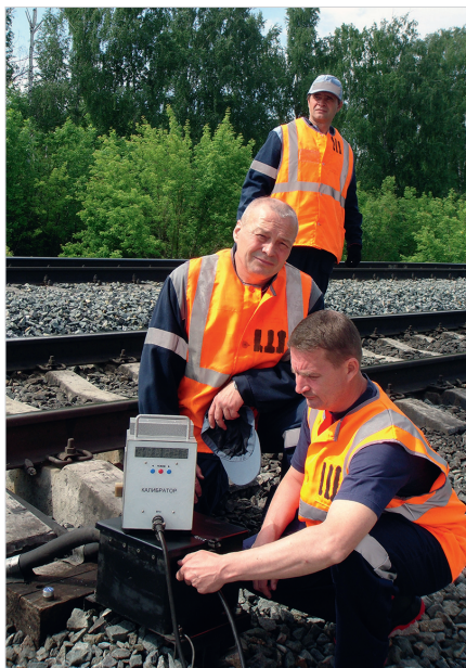
Электромеханики Н.Е. Гладков, В.В. Ильинский и П.И. Воротников (на заднем плане) во время калибровки каналов напольных камер
