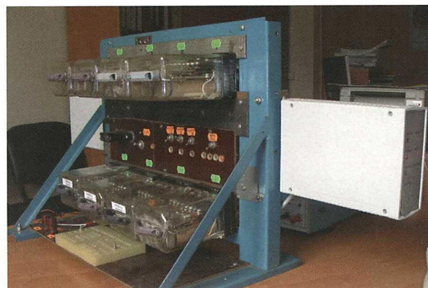
Стенд для испытаний ПАБ ЦКС с блоками БКУ-16/8
