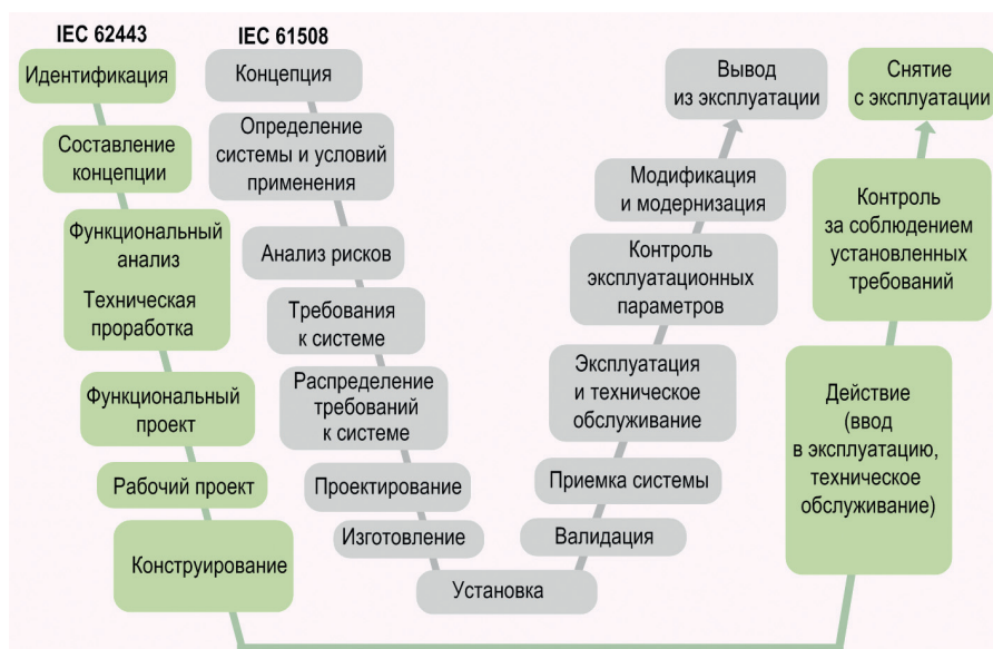
Жизненный цикл функциональной и информационной безопасности МПСУ ЖАТ согласно стандартам IEC 61508 и IEC 62443
