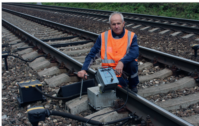
Электромеханик Ю.В. Митин выполняет калибровку каналов напольной камеры
