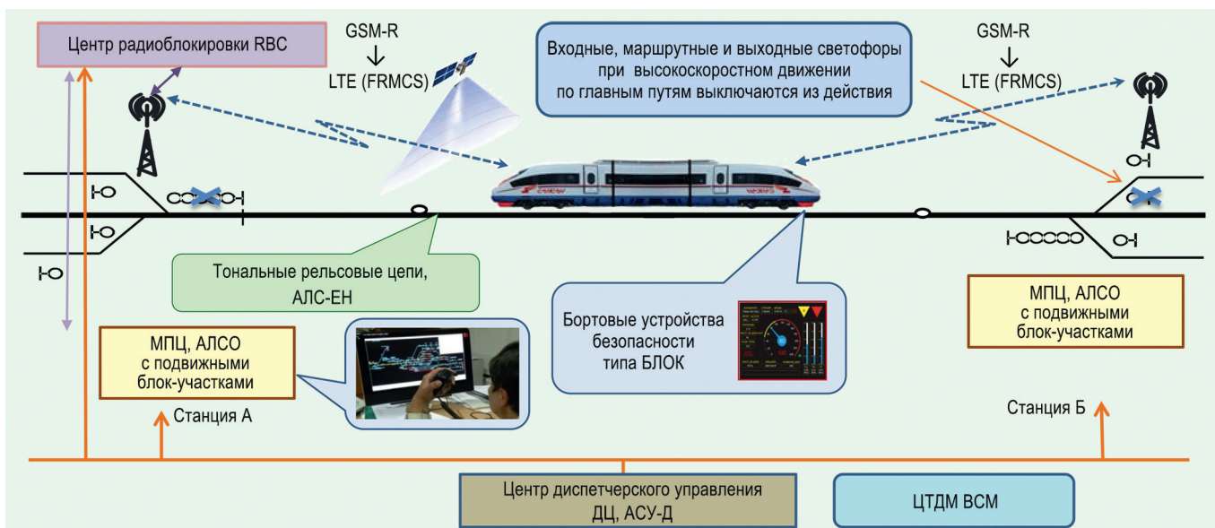
Предлагаемая система интервального регулирования движения поездов на перегонах и станциях ВСМ с дублированием каналов передачи информации на локомотив
