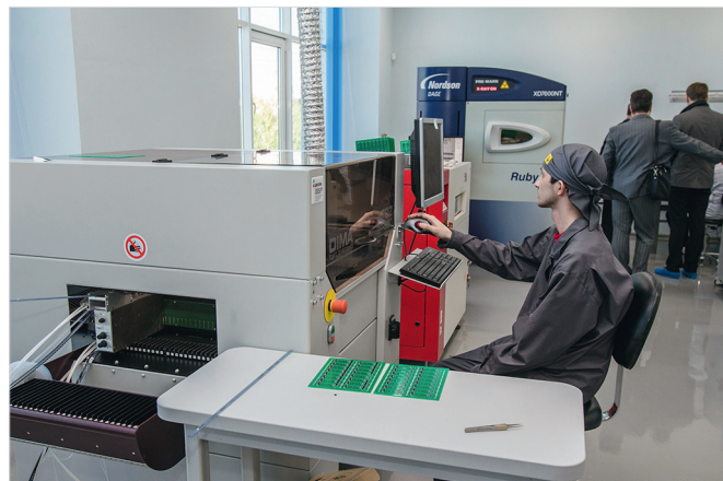
Работа на автомате по установке радиоэлектронных компонентов
