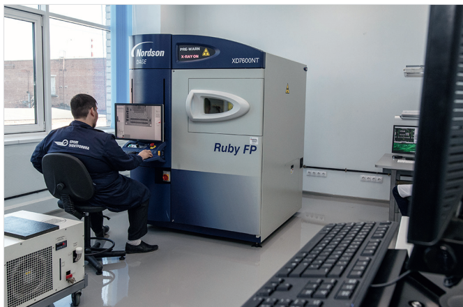
Контроль монтажа платы на рентген-установке DAGE
