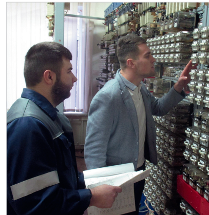
Поиск неисправности в схеме управления стрелкой в лаборатории «Устройства автоматики»
