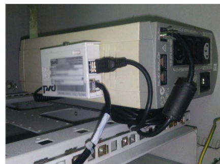
Подключенный микрокомпьютер Raspberry Pi к ИБП
