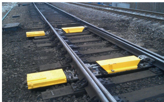
Электроприводы EBISwitch 2000 на стрелочном переводе с маркой крестовины 1/11
