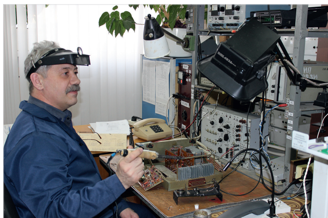
При пайке во время ремонта приборов электромеханик К.Ю. Иванов пользуется переносным дымоуловителем
