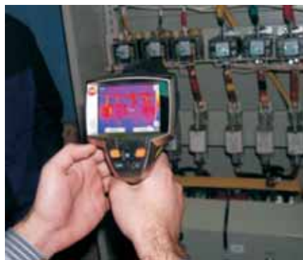
Термографическое обследование электроустановок
