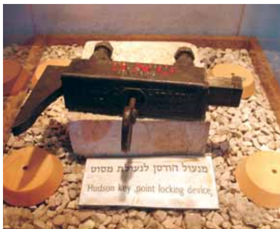
Аналог замка Мелентьева, который использовался на Израильских железных дорогах более полувека назад
