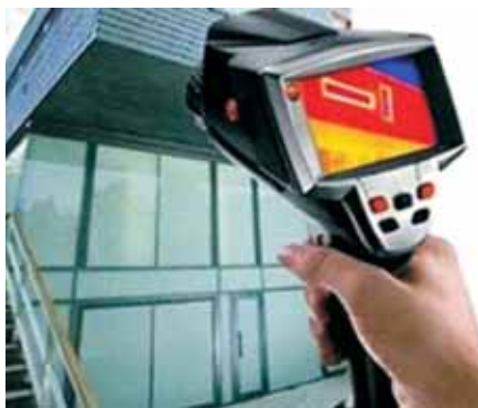
Термографическое обследование зданий с помощью тепловизора Testo 882
