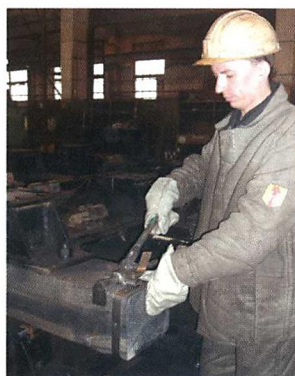
Окантовка бруса металлической лентой слесарем Н.И. Усовым
