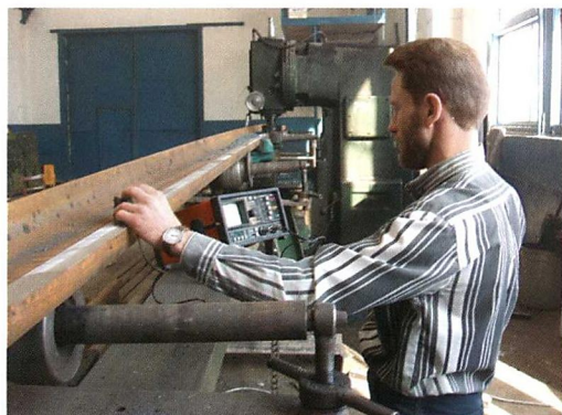
Ультразвуковой метод дефектоскопирования рельса начальником ОТК В.А. Лапшовым
