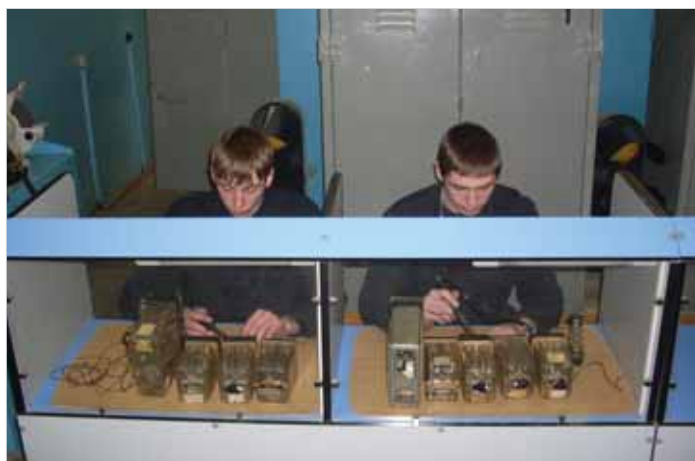
Монтажные верстаки выполнены по специальному заказу – каждое рабочее место оснащено низковольтной розеткой, светильником и защитными ограждениями
