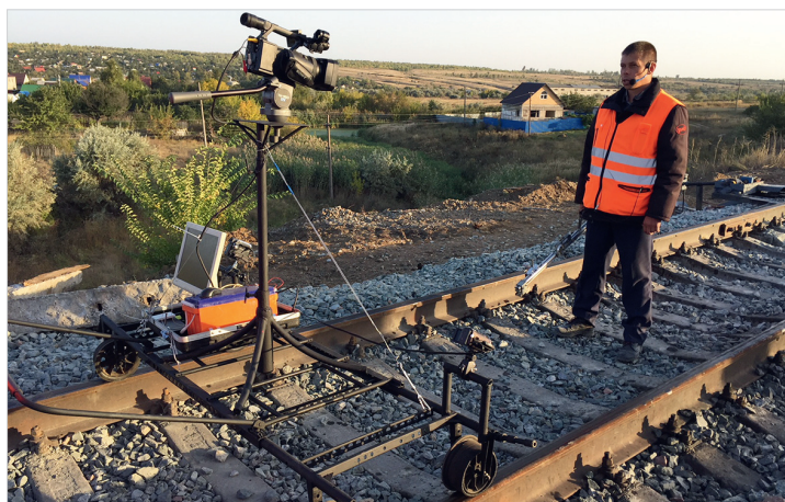
Модернизированная дефектоскопная тележка с видеооборудованием
