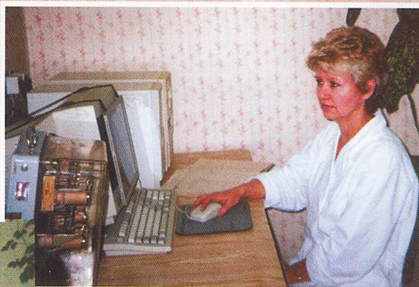
Электромеханик Челябинской дистанции Т.А. Ефимова проверяет на компьютеризированном стенде релейные блоки
