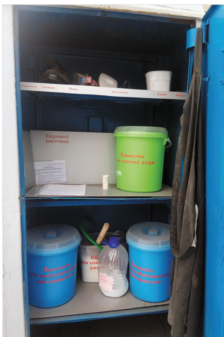
Шкаф и специальная емкость для организации процесса утилизации аккумуляторной кислоты в Иркутск-Сортировочной дистанции
