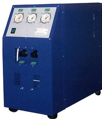
Блок осушки и управления установки Муссон-Н
