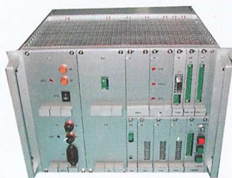
Генератор сигналов танальных рельсовых цепей, сигналов АЛСН и АЛС-ЕН (ГТРЦ)
