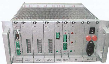
Приемник сигналов танальных рельсовых цепей с цифровой обработкой сигналов (ПТРЦ)
