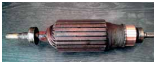
Якоря с оборванной (слева) и восстановленной (справа) обмотками
