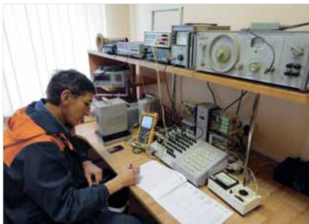
Электромеханик-приемщик А.С. Мартынов за проверкой аппаратуры тональных рельсовых цепей
