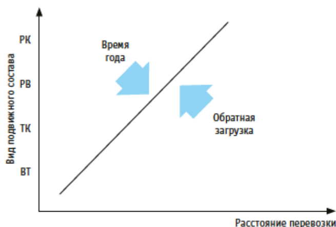
Рис. 1. Факторы влияния на выбор вида изотермического подвижного состава в зависимости от расстояния перевозки: РК — рефрижераторный контейнер; РВ — вагон рефрижераторной секции; ТК — термос-контейнер; ВТ — вагон-термос
