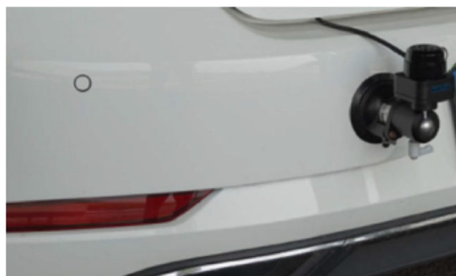
Рис. 1. Устройство RPLIDAR, закрепленное на задней части головного автомобиля
