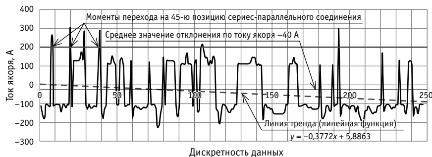
Рис. 6. Осциллограмма отклонений по току якоря электровоза 2ЭС6 № 348 из группы локомотивов без замечаний по якорным и компенсационным обмоткам
