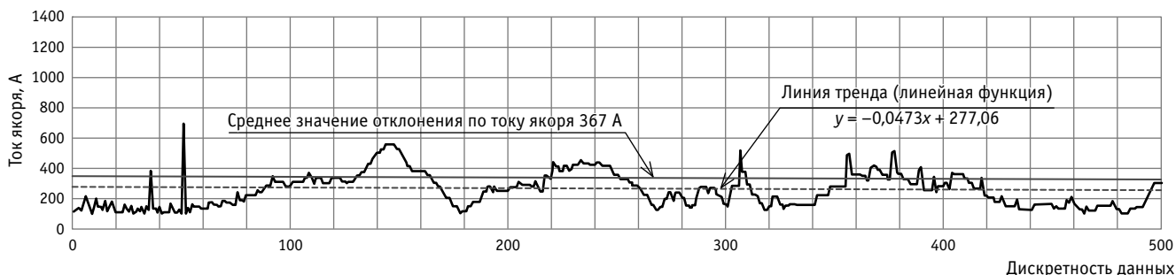
Рис. 4. Осциллограмма отклонений по току якоря электровоза 2ЭС6 № 17 из группы локомотивов с замечаниями по якорной и компенсационной обмотке
