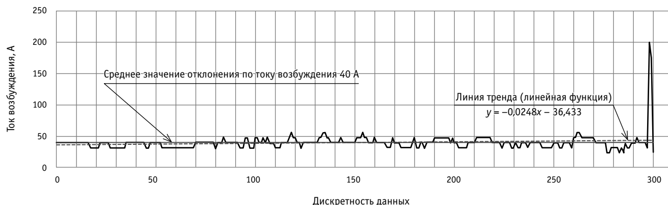
Рис. 5. Осциллограмма отклонений по току возбуждения электровоза 2ЭС6 № 496 из группы локомотивов с замечаниями по обмоткам возбуждения
