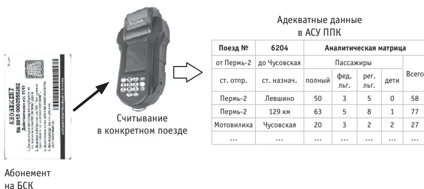
Рис. 5. Считывание абонементных билетов в пригородных поездах
