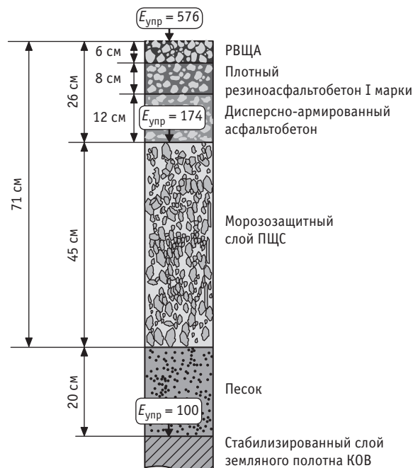
Рис. 4. Пример нежесткой конструкции строения пути для ВСМ
