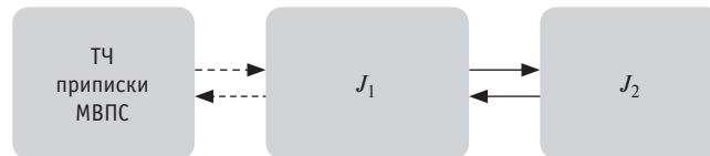
Рис. 4. Передислокация (засылка) к новому месту формирования туристических поездов: J_1, J_2 — возможные начальные, промежуточные и конечные пункты маршрутной сети (прямыми стрелками показаны направления обслуживания маршрута туристического поезда, пунктирными — порожний пробег МВПС)
