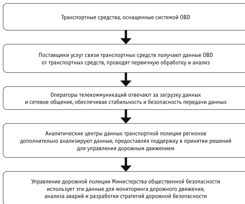
Рис. 1. Процесс передачи данных OBD от транспортного средства к органам принятия решений по безопасности дорожного движения
