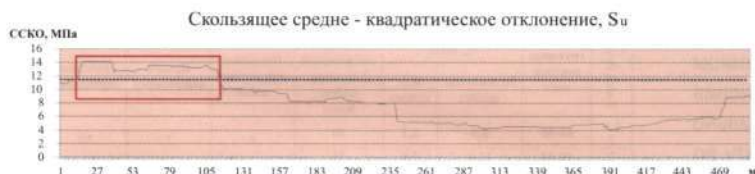
Рисунок 4 – Фрагмент графика S_U на участке для оценки потребности в работах по восстановлению равноупругости пути
