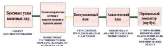
Рисунок 6 – Структурная схема радиоуправляемой акустико-эмиссионной системы диагностики буксовых узлов
