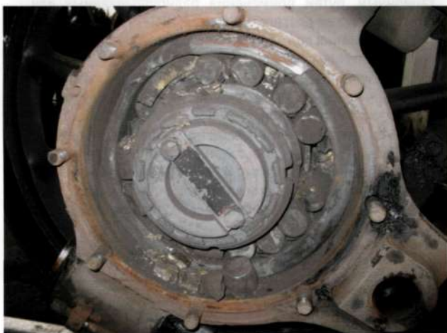
Рисунок 4 – Буксовый узел пассажирского электровоза ЧС 2Т, имеющий трещину наружного кольца в эксплуатационной зоне (верхняя часть узла)
