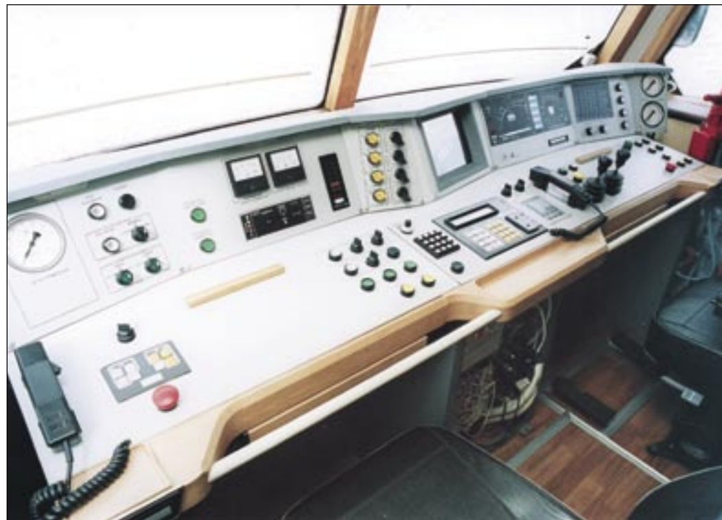
Рисунок 3 — Пульт управления локомотивом
