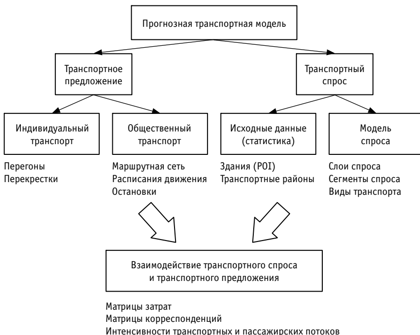
Рис. 1. Структура основных составляющих прогнозной транспортной модели
