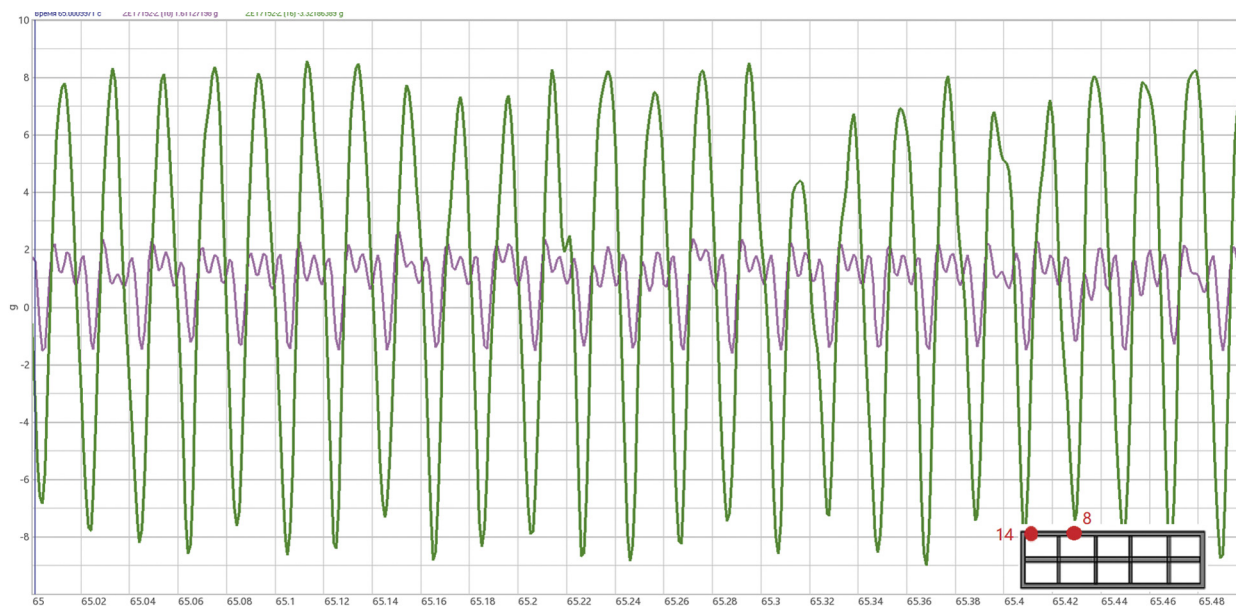
Рис. 2. Графики ускорения во времени по оси Z для точек 14 (зеленая линия) и 8 (сиреневая линия)
