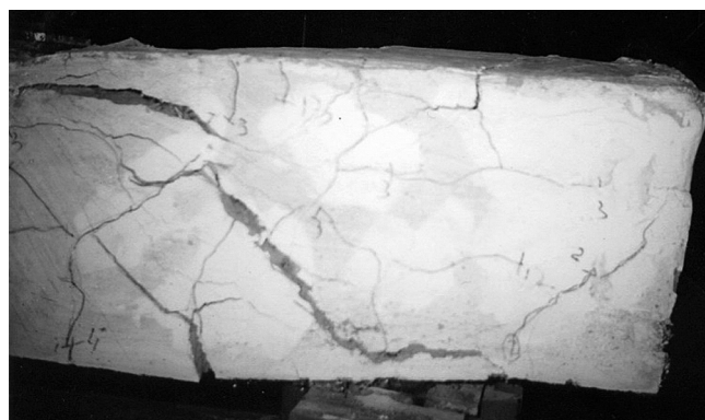
Рис. 1. Особенности трещинообразования фибробетона при испытаниях железобетонной перемычки на несущую способность
