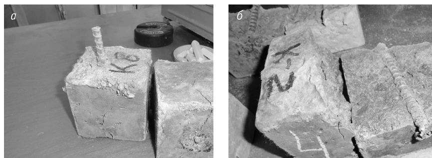
Рис. 2. Особенности разрушения бетонных образцов в результате испытаний на выдергивание стеклопластиковой стержневой арматуры диаметром 6 и 12 мм: а — фибробетон; б — бетон
