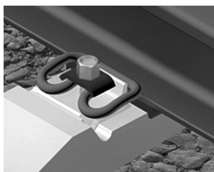
Рис. 2. Внешний вид рельсового крепления ЖБР-65Ш
