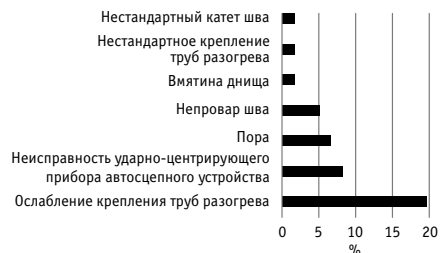
Рис. 3. Повреждения вагонов-цистерн в эксплуатации
