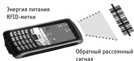
Рис. 2. Принцип передачи данных RFID-технологии
