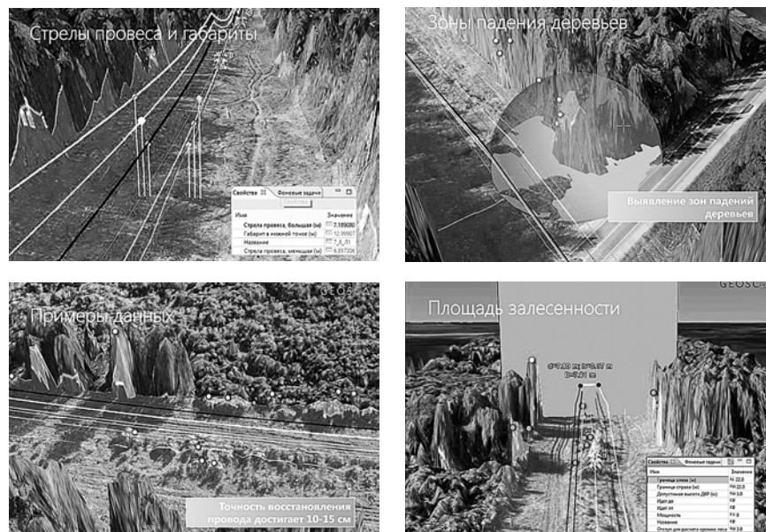
Рис. 10. Аэрофотосъемка для создания ортофотопланов и моделей трассы
