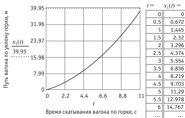
Рис. 3. Графическая зависимость пройденного расстояния при вариации времени скатывания вагона по уклону горки
