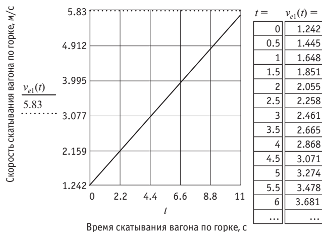
Рис. 2. Графическая зависимость скорости при вариации времени скатывания вагона по уклону горки
