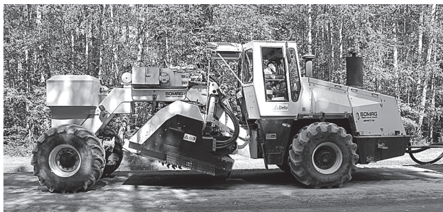
Рис. 4. Ресайклер BOMAG MPH 122
