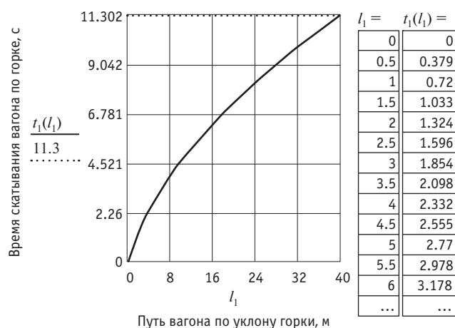
Рис. 1. Графическая зависимость времени скатывания вагона при вариации длины первого скоростного участка горки
