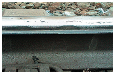
Рис. 6. Лубрикант на рельсе после прохода грузового состава массой 4125 т
