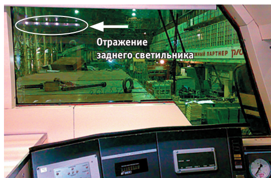
Рис. 4. Отражение от светильников в лобовом стекле при положении машиниста стоя
