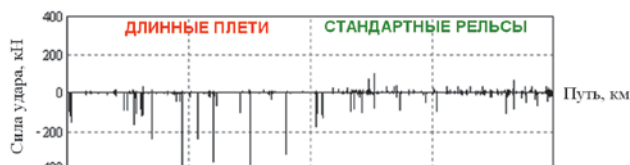
Рисунок 3 — Фрагмент рабочей записи ускорений буксового узла при движении на длинных рельсовых плетях и стандартных рельсах
