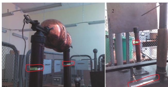
Рисунок 7 — Исследование влияния на считывание пассивной RFID-метки М3:
