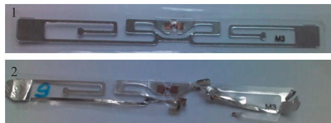
Рисунок 4 — Метка М3: 1 — до испытаний; 2 — после прохождения тока
