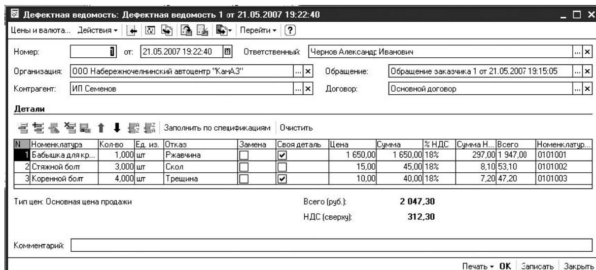
Рисунок 4 — Формирование документа «Дефектная ведомость»
