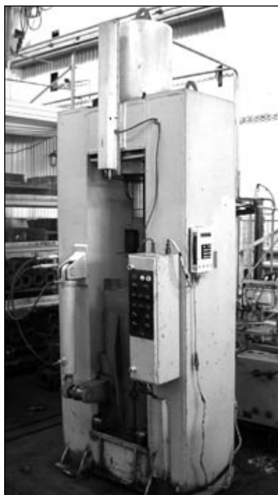
Рисунок 1 — Стенд для ремонта и испытаний поглощающих аппаратов грузового подвижного состава СПА-160
