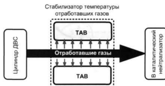
Рисунок 1 – Принципиальная схема процесса стабилизации температуры отработавших газов в выпускном тракте дизеля, оборудованном стабилизатором температуры наддувочного воздуха при T_{ог. ср.} > T_{тав. ср.}
