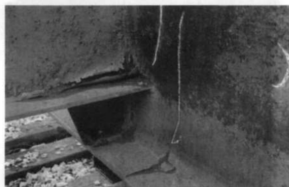
Рисунок 3 – Трещина в нижней части хребтовой балки
