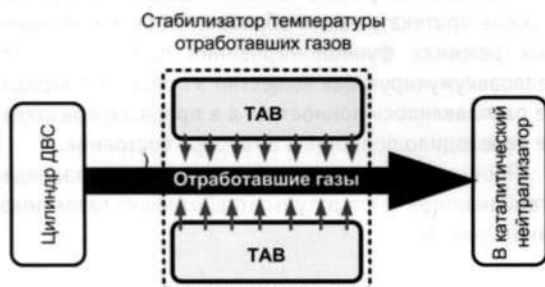
Рисунок 5 – Принципиальная схема процесса стабилизации температуры отработавших газов в выпускном тракте дизеля, оборудованном стабилизатором температуры отработавших газов
