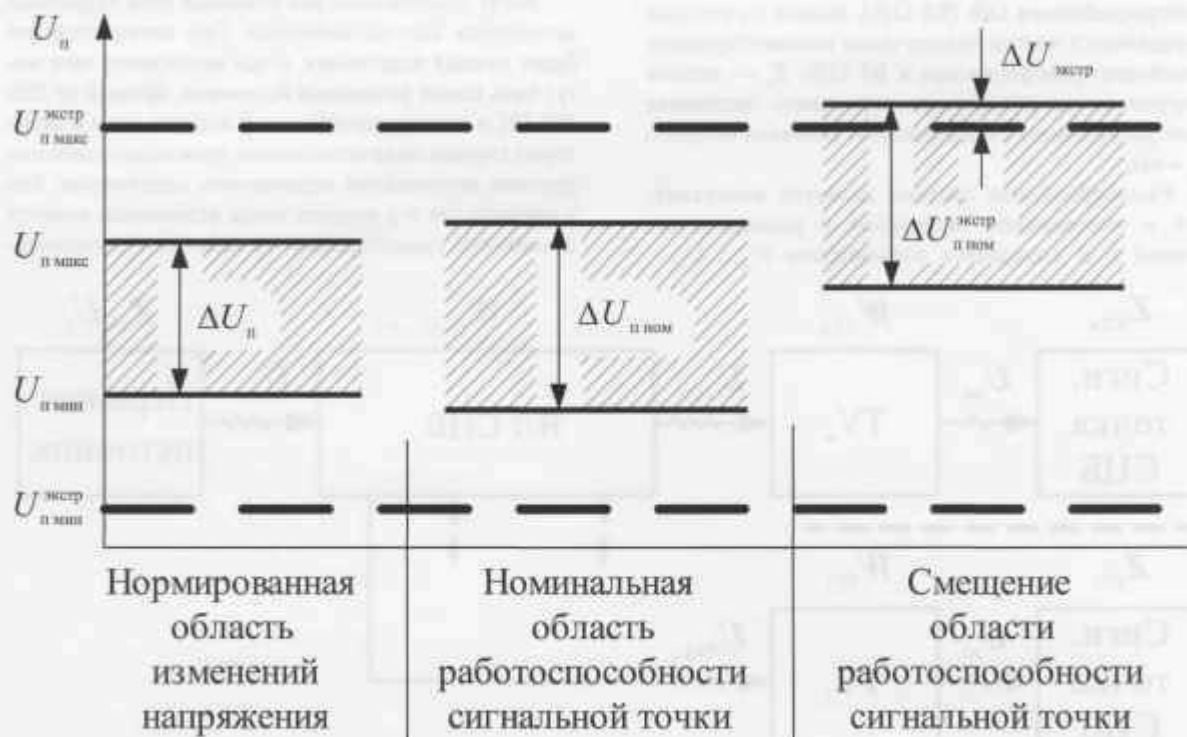
Рисунок 3 — Иллюстрация сравнения областей изменения напряжения U_n и функционирования сигнальных точек СЦБ
