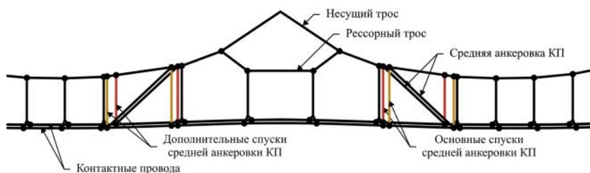
Рис. 3. Модернизированная конструкция узла троса средней анкеровки
