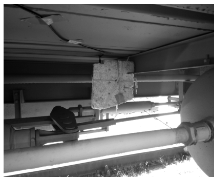
Рис. 4. Расположение микрофона с предусилителем в защитном кожухе в подвагонном пространстве среднего сечения кузова
