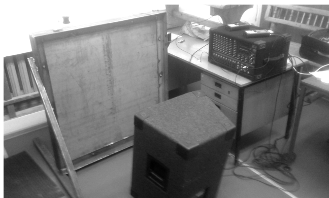
Рис. 6. Стенд для имитации акустического воздействия на элемент металлического пола вагона
