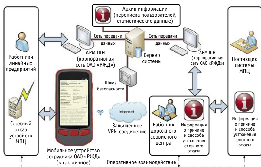
Рис. 2. Архитектура системы управления инцидентами
