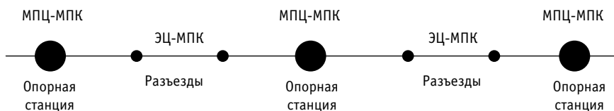
Рис. 1. Структурная схема перспективной КМСУДП
