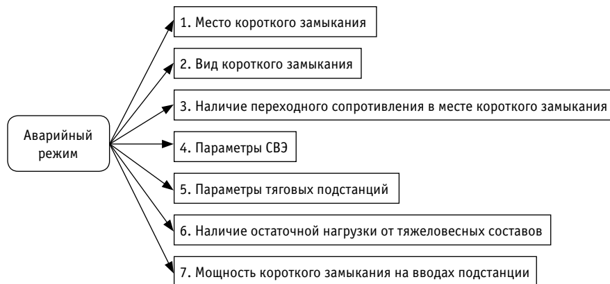
Рис. 6. Параметры аварийного режима, влияющие на работу ДЗ ФКС
