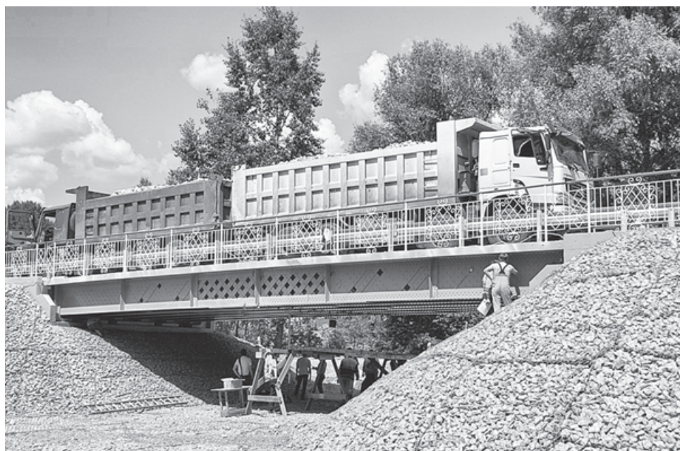
Рис. 7. Общий вид гибридного по материалу автодорожного моста во время загрузки испытательной нагрузкой
