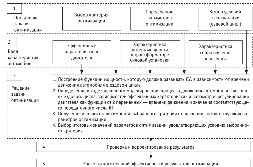
Рис. 1. Структурная схема метода оптимизации передаточных чисел механической ступенчатой трансмиссии
