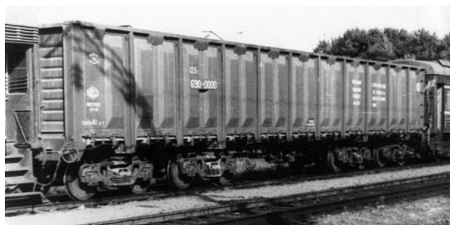
Рисунок 3 — Опытный восьмиосный полувагон с опиранием кузова на скользящие двухосные тележки с клиновой балансирующей системой
