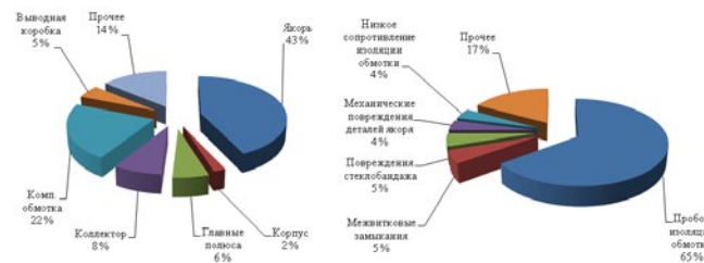
Рисунок 1 — Распределение отказов по элементам тяговых электродвигателей серии ТЛ-2К1 и их якорей
