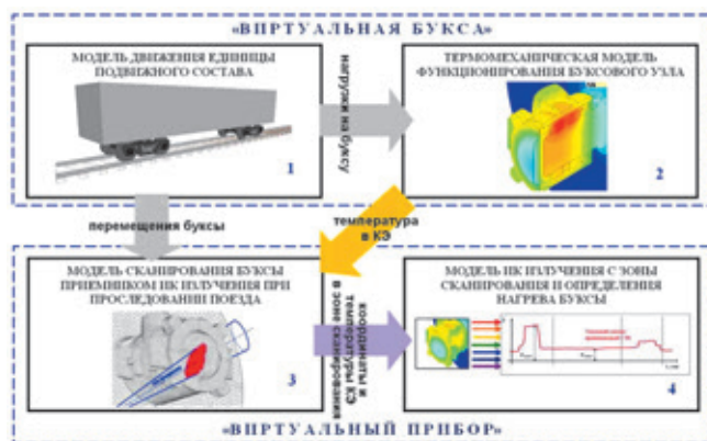
Рисунок 1 — Схема виртуальной диагностической модели бесконтактного теплового контроля
