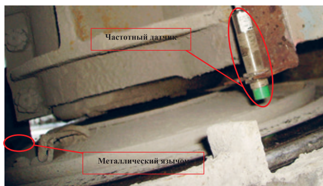
Рисунок 8 — Монтаж датчика регистрации скорости движения трамвая
