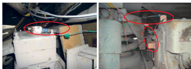
Рисунок 7 — Размещение датчиков перемещений на тележке
