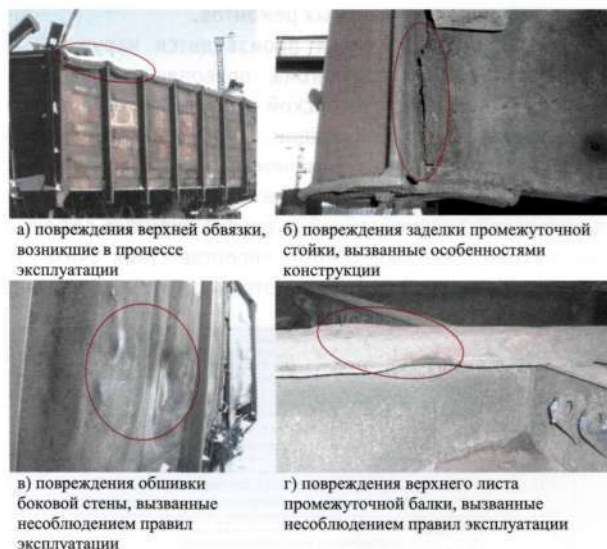
Рисунок 2 – Характерные повреждения кузова полувагона
