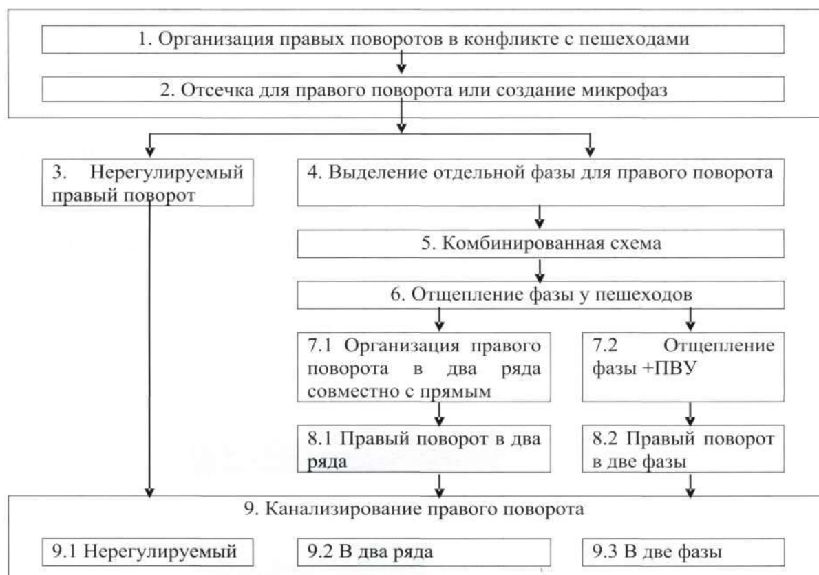
Рисунок 1 — Схема стадийного совершенствования правых поворотов в узлах
