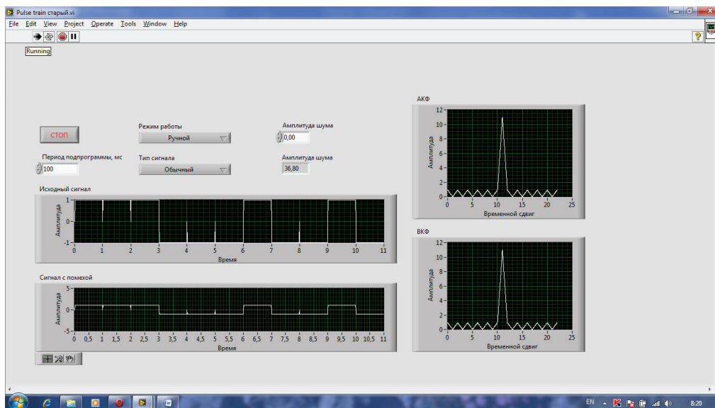
Рис. 4. 11-элементный сигнал Баркера и его АКФ
