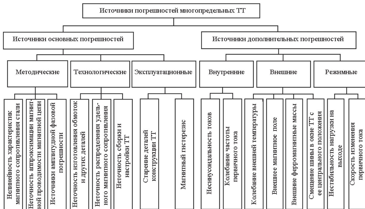
Рис. 2. Классификация источников погрешностей широкодиапазонного ТТ
