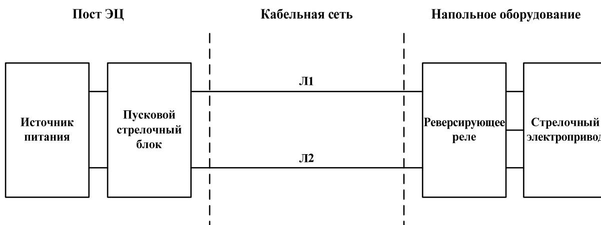
Рис. 1. Функциональная схема управления стрелочным электроприводом с двигателем постоянного тока
