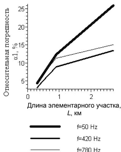
Рис. 3 Относительная погрешность при длине рельсовой линии 27 км и сопротивлении изоляции 0,5 Ом·км
