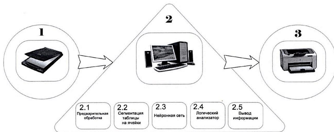
Рис. 5 Процесс распознавания схем с помощью модуля АРМ-РМД
