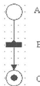
Рис. 2. Модель операции логического отрицания
