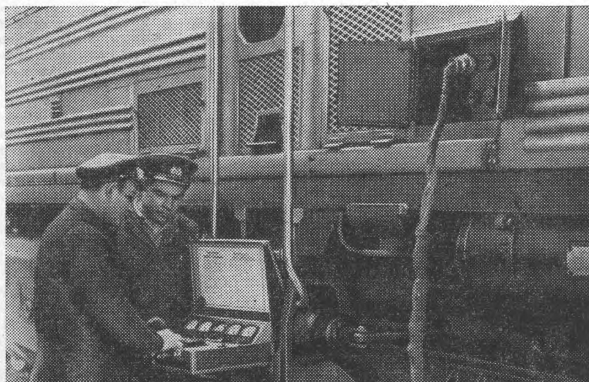
Рис. 1. Проверка параметров схемы возбуждения главного генератора переносным устройством
