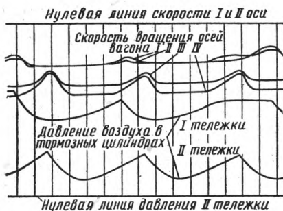
Рис. 4. Осциллограмма срабатывания противоюзных устройств
