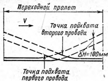
Рис. 2. Рекомендуемое расположение контактных проводов в переходном пролете сопряжения анкерных участков
