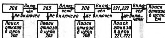
Рис. 1. Последовательность проверки срабатывания аппаратов при наборе позиций
