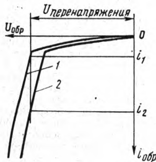
Рис. 1. Суммарная обратная характеристика рядов подобранных вентилялей (кривая 1) и ряда, в котором подбор нарушен (кривая 2)
