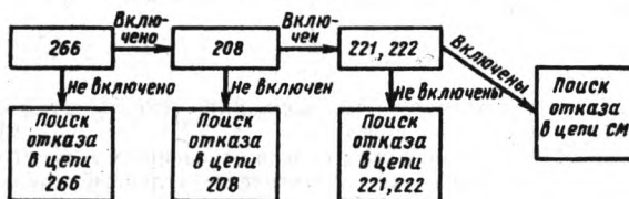
Рис. 6. Последовательность проверки срабатывания аппаратов при сбросе позиций
